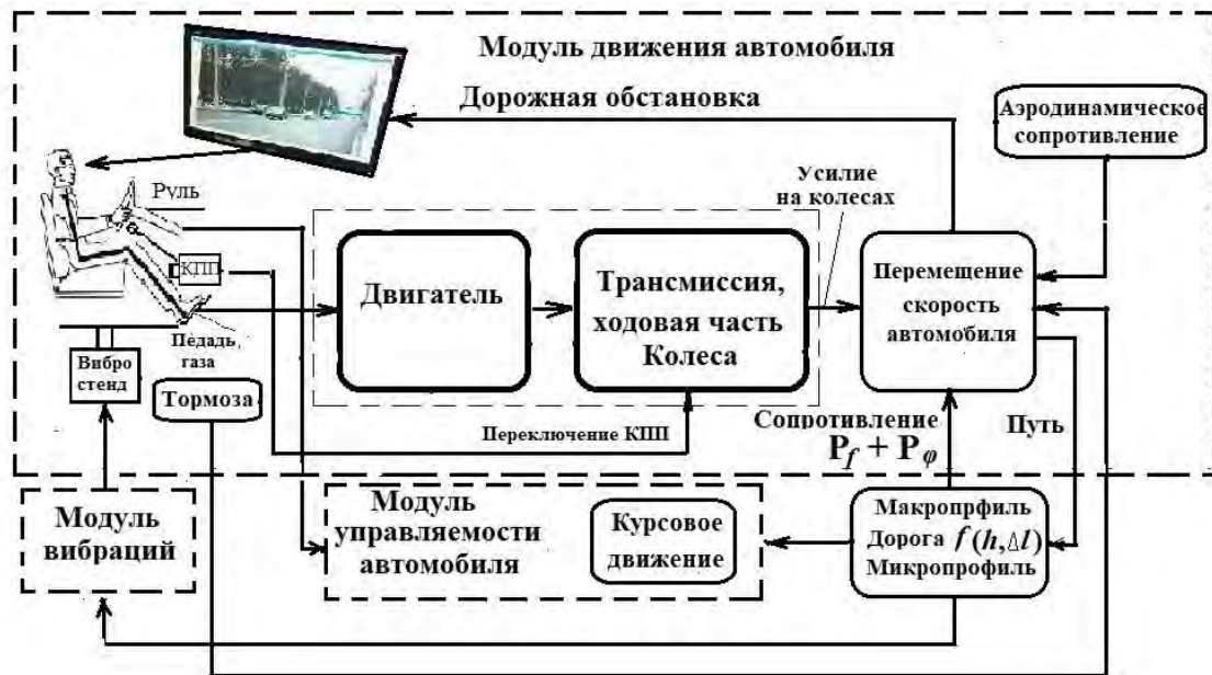
Рисунок В.5. – Структурная схема связей основных подсистем
