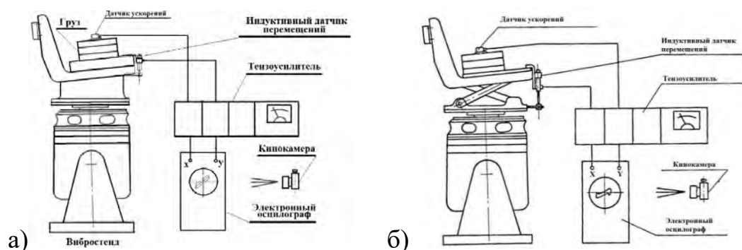
Рисунок 4.16. – Схема замеров и регистрации динамических характеристик подушки (а) и подвески сиденья (б)
