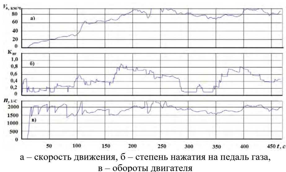
Рисунок 5.27 – Результаты имитационного моделирования движения автомобиля при ручном переключении передач КПП
