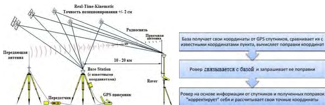
Рисунок 2.8. – Принцип измерения спутниковыми приемниками трехмерного вектора
