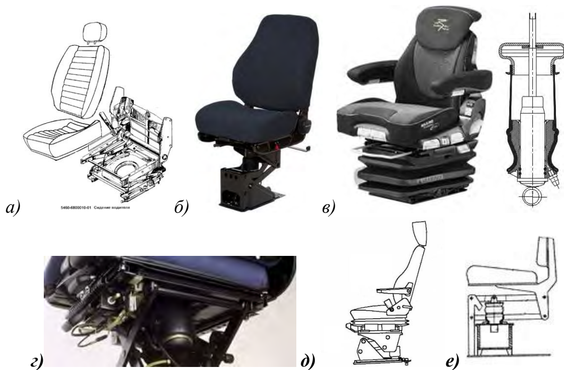
а – подрессоренное сиденье Viking-300; в, г – сиденья с ножнично-рычажной пневмоподвеской с рукавным элементом; б, д, е – с четырехрычажной схемой подвески
