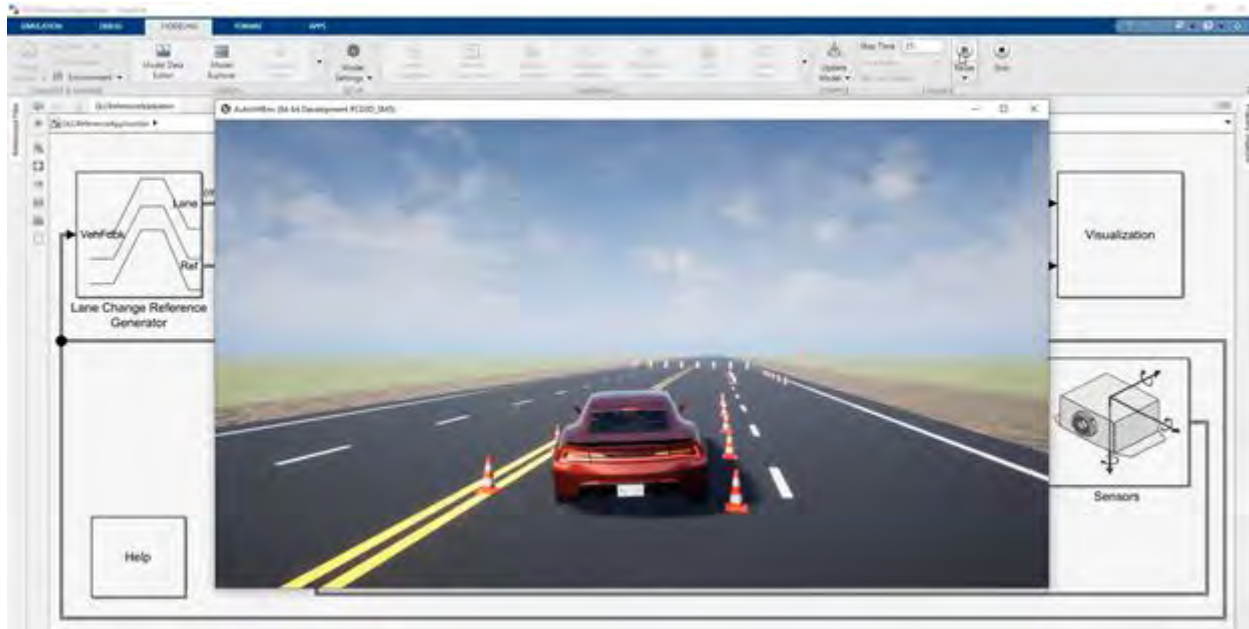
Рисунок 7.32. – Реализация визуализации дорожной обстановки в Simulink
