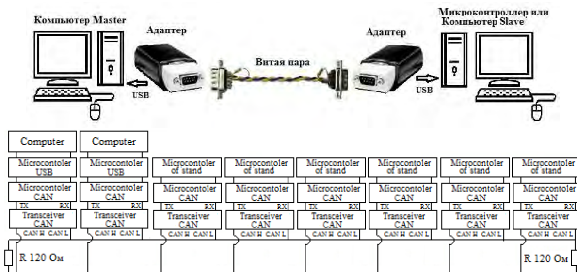
Рисунок 3.51. – Предлагаемая общая схема передачи данных с Simulink на стенд
