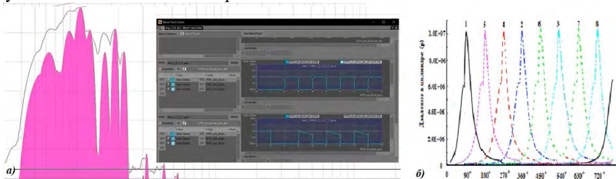
Рисунок 7.25. Спектр моделируемого звука в двигателя в синтезаторе в работе [13] (а) и использованная автором индикаторная диаграмма двигателя V8 (б)
