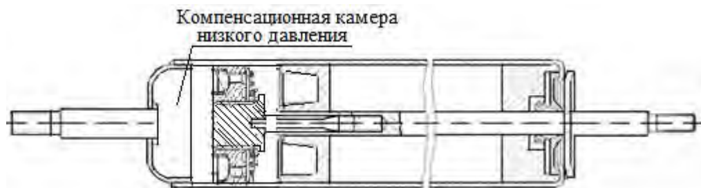
Рисунок 4.31. – Предлагаемая конструкция регулируемого амортизатора для сиденья
