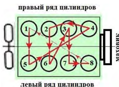
Рисунок 2.21. – Порядок работы цилиндров V8-образного двигателя
