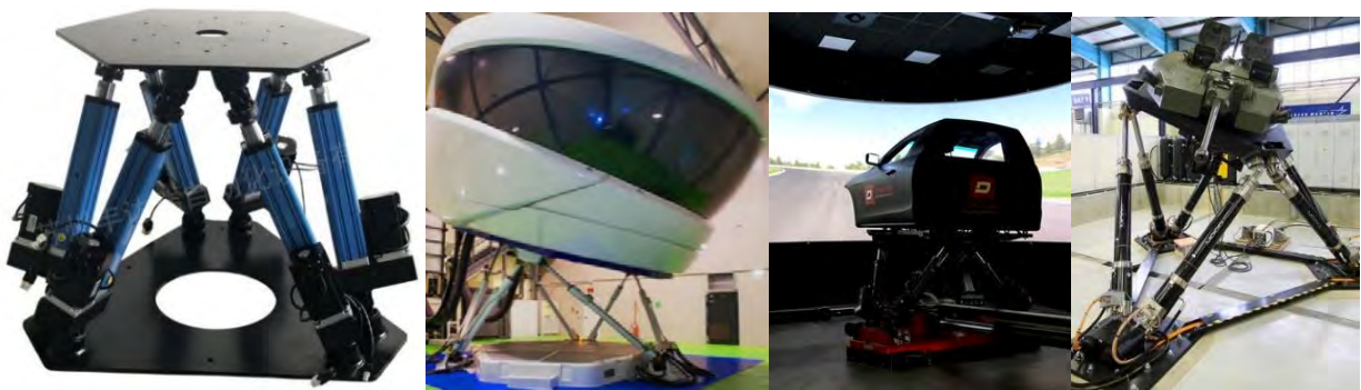
Рисунок 7.9. – Конструкция платформы, симуляторы самолета, автомобиля, танка
