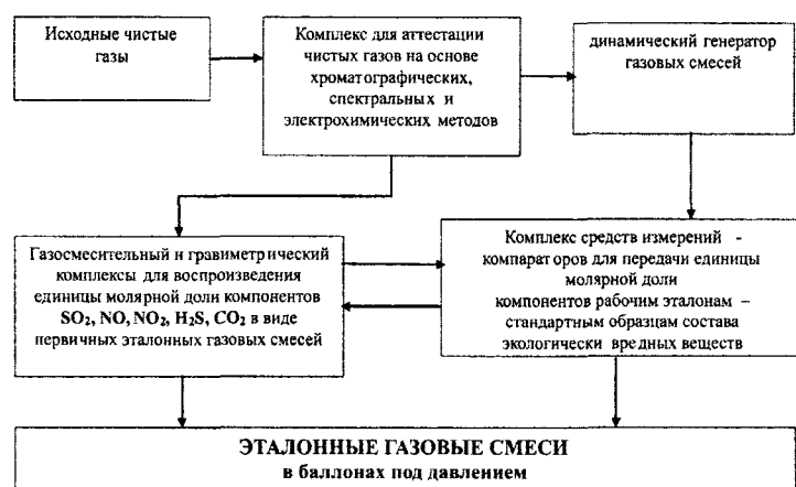
Функциональная блок-схема эталона единицы молярной доли атмосферных экологически опасных компонентов \text{SO}_2 , \text{NO} , \text{NO}_2 , \text{H}_2\text{S} , \text{CO}_2
