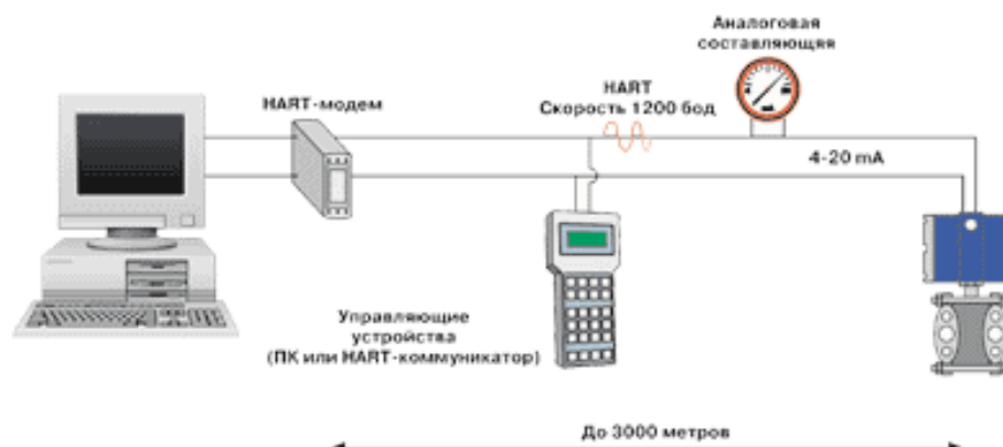
Рисунок 6.6 – Режим передачи цифровой информации одновременно с аналоговым сигналом
