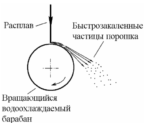
Рис. 20. Принципиальная схема распыления порошка из расплава при помощи водоохлаждаемого барабана
