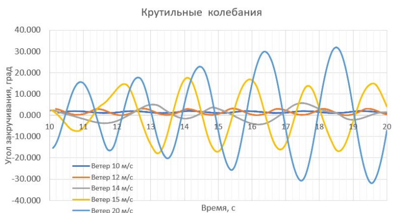
Рис. 11. Графики вертикальных ( a ) и крутильных ( б ) колебаний струнного рельса при различных скоростях поперечного ветрового воздействия без применения жесткой связи с тросом грозозащиты
