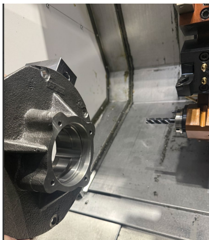
Рис. 5. Заготовка с обработанной внутренней поверхностью с револьверной головкой токарного станка
