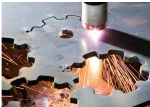
Рис. 2.8. Процесс плазменной резки металла
