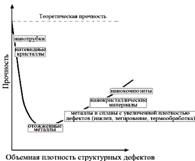
Рис. 1.16. Схематическая зависимость прочности от плотности атомарных дефектов в материале
