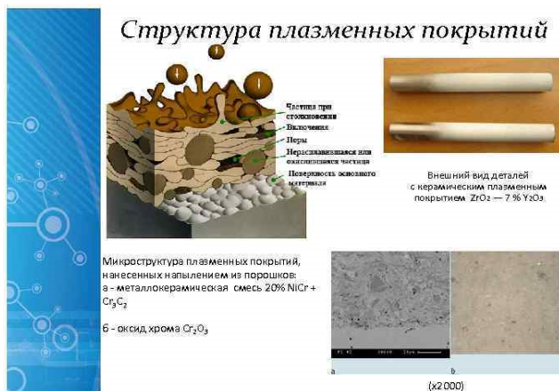
Рис. 2.12. Схема формирования плазменных покрытий и их структура
