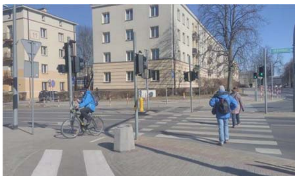
Рис. 3. Организация наземного регулируемого пешеходного перехода с выделенной полосой велодвижения в г. Белосток
