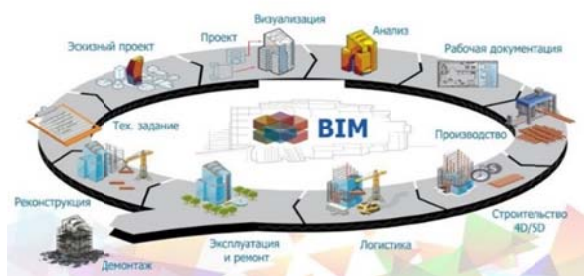
Рис. 4. Жизненный цикл сооружения
