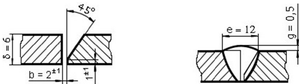
Рис. 2.9. Эскиз сварного соединения
