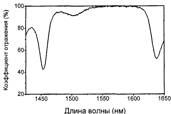
Рисунок 2 – Спектр отражения пассивного затвора SESAM
