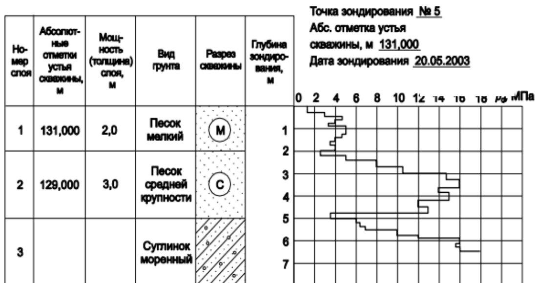
Рис. 2.2. График динамического зондирования, совмещенный с инженерно-геологической колонкой
