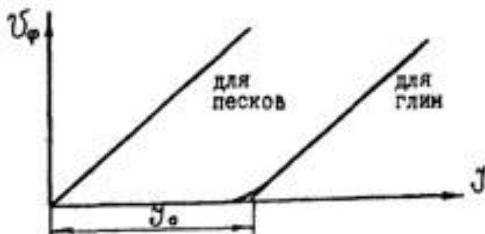
Рис. 15.4. Зависимость между скоростью фильтрации и гидравлическим градиентом
