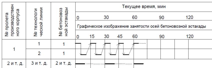
Рис. 7.1. Сводный график работы технологических линий
