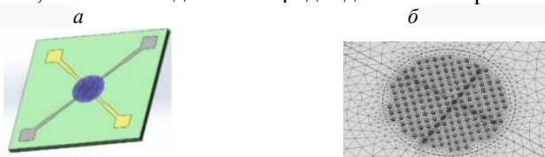
Рис. 1. 3D модель газового сенсора (а) и сетка конечных элементов на чувствительном слое (б)
