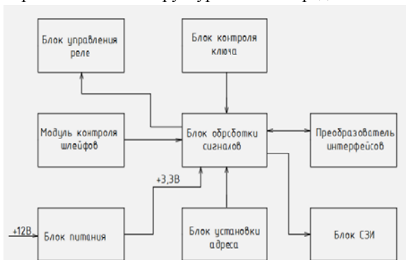
Рис. 1. Структурная схема адресного блока интегрированной системы безопасности
