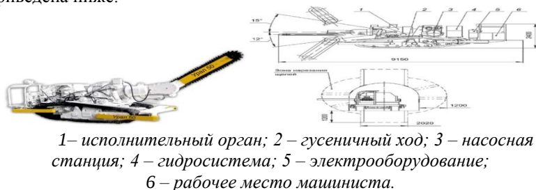
Рисунок 1 - Конструктивная схема щеленарезной машины "Урал 50"
