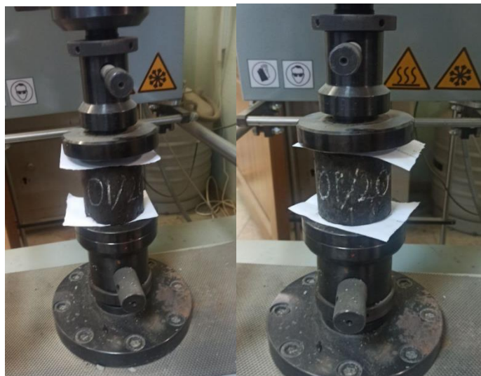
Рисунок 1 – Испытание образцов на сжатие при температуре 50 °С
