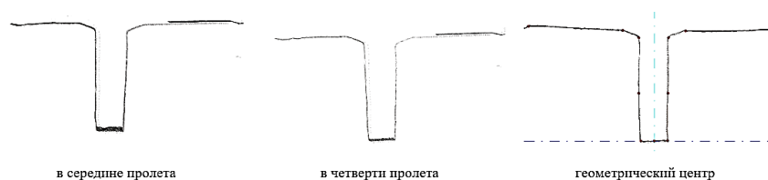
Рисунок 5. – Поперечный разрез облака точек балки пролетного строения
