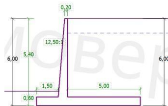
Рисунок 3. Размеры стены при уровне грунтовых вод 1 м.
