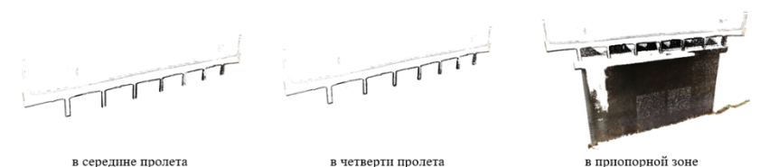
Рисунок 4. – Поперечный разрез облака точек моста
