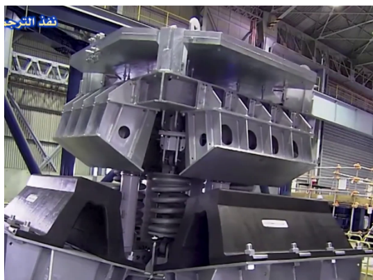
Рисунок 3. - Пример конструкции фундамента
