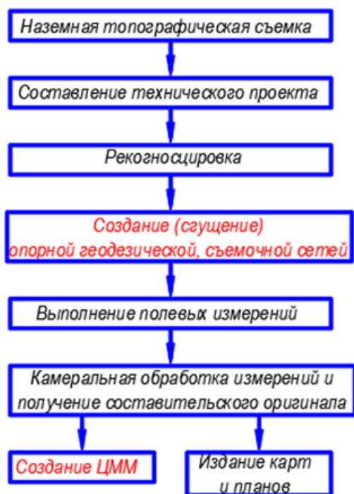
Рис.3.2 Обобщенная технологическая схема производства наземной топорсъемки
