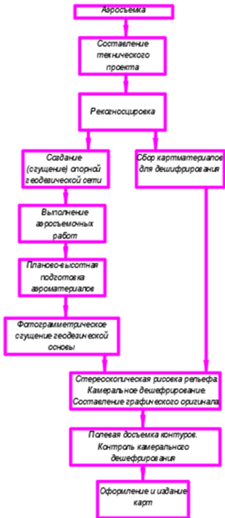
Рис. 3.4 Обобщенная технологическая схема аэросъемки.
