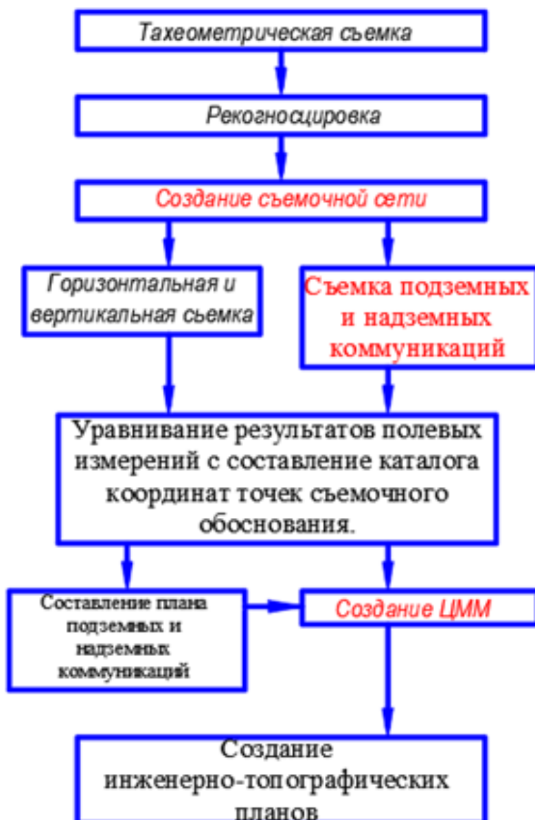
Рис. 3.3 Технологическая схема тахеометрической съемки.
