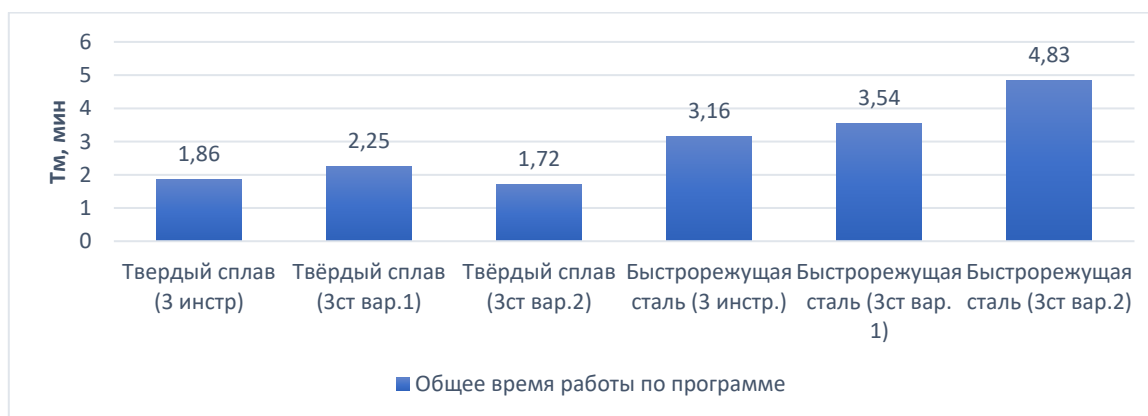
Рисунок 3 – Машинное время при различных стратегиях обработки
