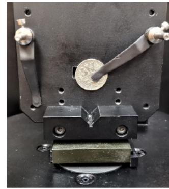
Рис. 5. Схема установки и ориентации монеты для измерения коэффициента отражения
