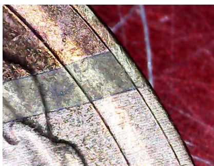
Рис. 2. Дефекты очистки поверхности в виде полос при шаге 0,1 мм
