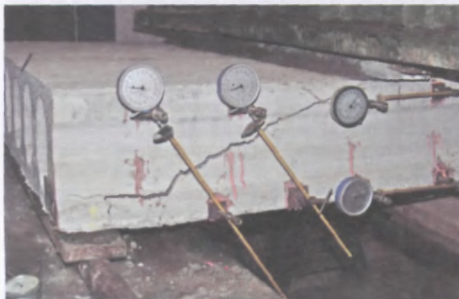
Рис. 9. Общий вид разрушения плит первой серии по наклонным сечениям при испытаниях на сдвиг
