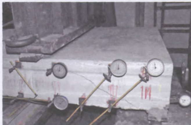
Рис. 9. Общий вид разрушения плит первой серии по наклонным сечениям при испытаниях на сдвиг
