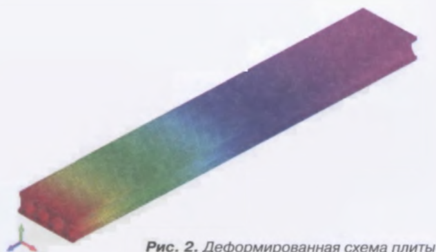
Рис. 2. Деформированная схема плиты
