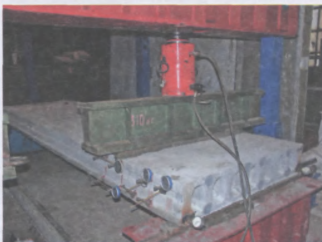
Рис. 8. Общий вид испытаний многопустотных плит на сдвиг
