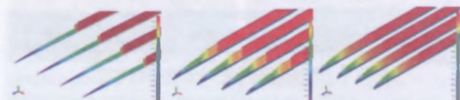
Рис. 4. Распределение напряжений по длине зоны передачи напряжения канатов при различных законах "усилие — перемещение"
