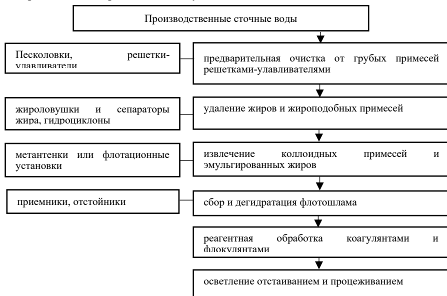
Рисунок 1 - Схема основных этапов очистки производственных сточных вод предприятий пищевой промышленности
