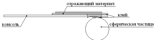
Рисунок – Зонд АСМ со сферической частицей порошка
