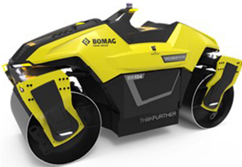
Рис. 9.2. Беспилотный каток компании BOMAG модели BW 154 AP-Robomag
