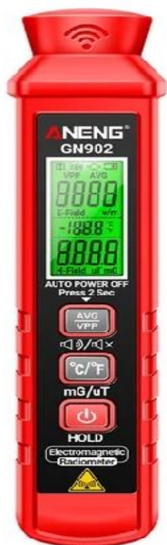
Рисунок 23 – Прибор для измерения интенсивности облучения в СВЧ диапазоне.
