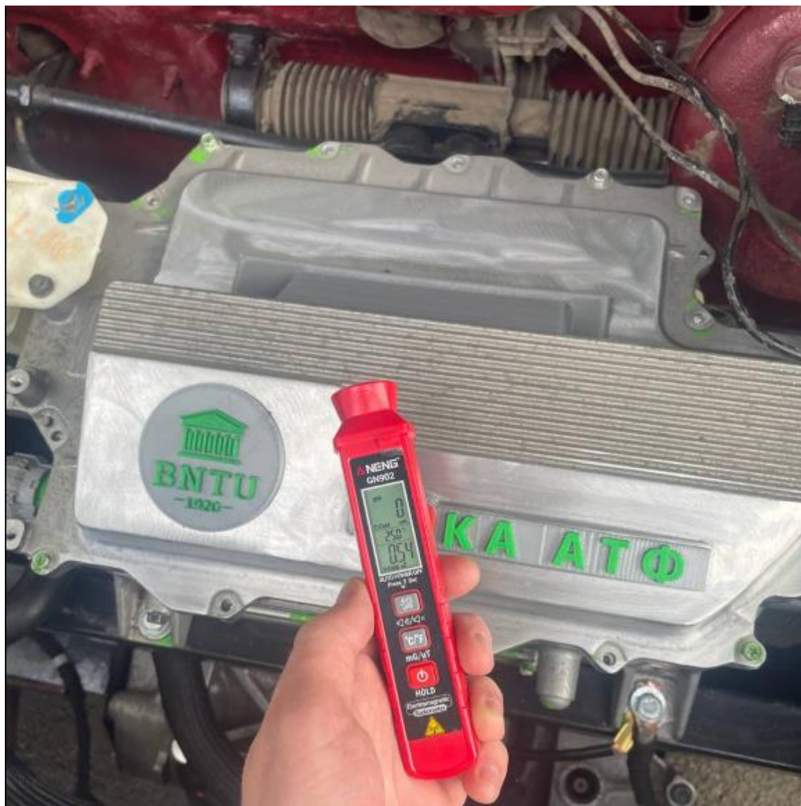
Рисунок А4– Замер интенсивности облучения в СВЧ диапазоне
