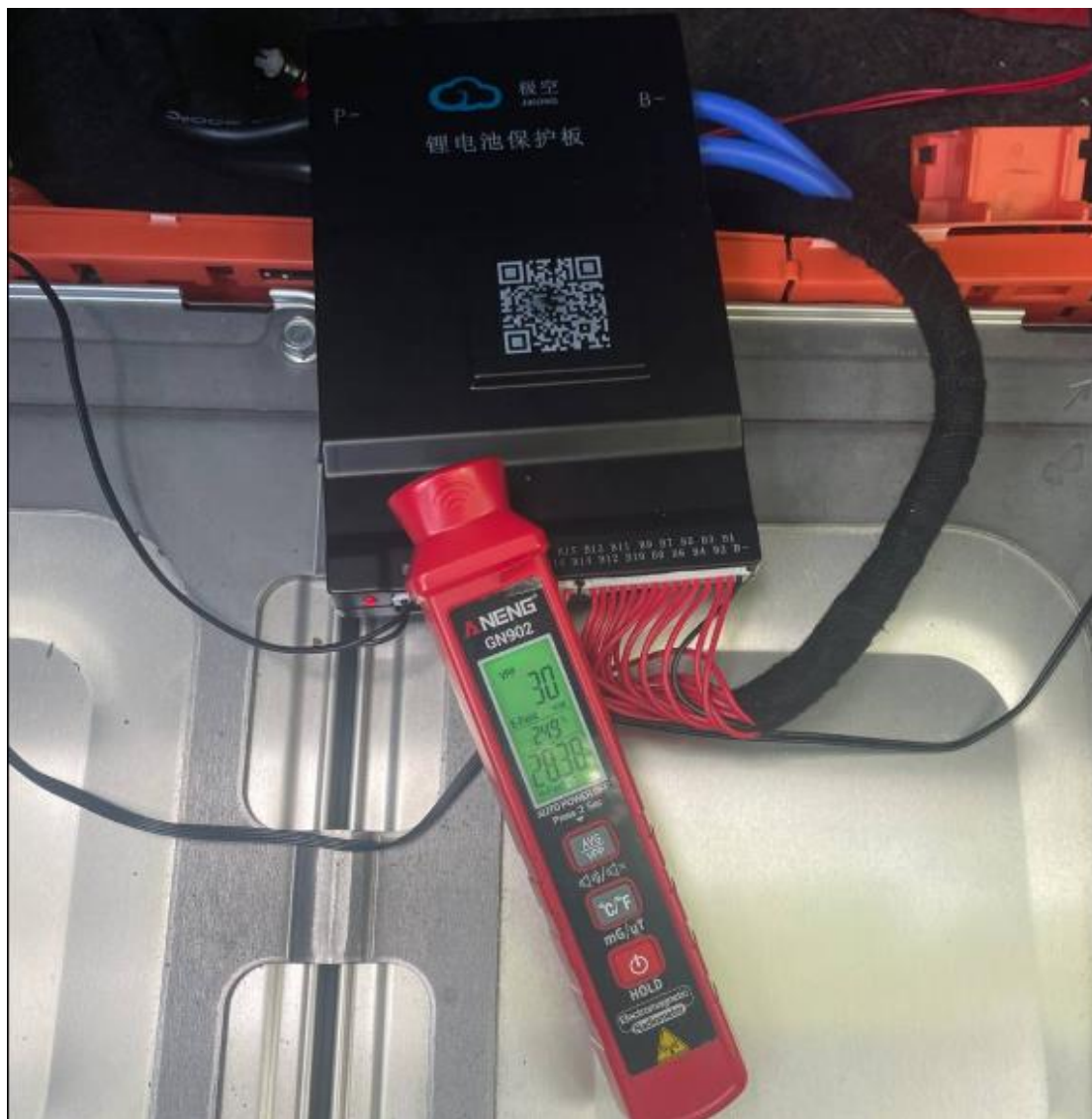
Рисунок А5– Замер интенсивности облучения в СВЧ диапазоне
