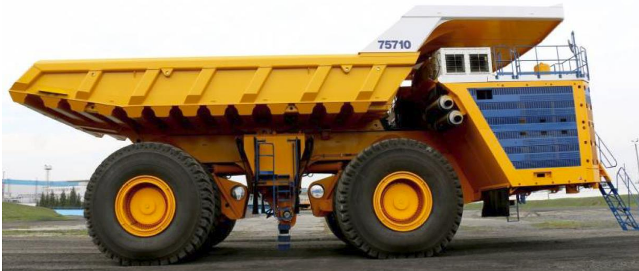
Рисунок 12 - Общий вид карьерного самосвала БЕЛАЗ-75710 грузоподъёмностью 450 тонн.
