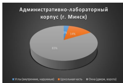
Рис. 5. Дефект конструкций в общем объеме дефектов
