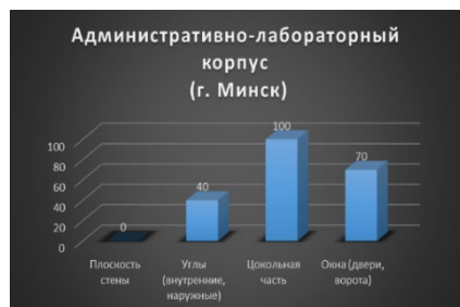
Рис. 4. Процент конструкций с теплотехническими дефектами
