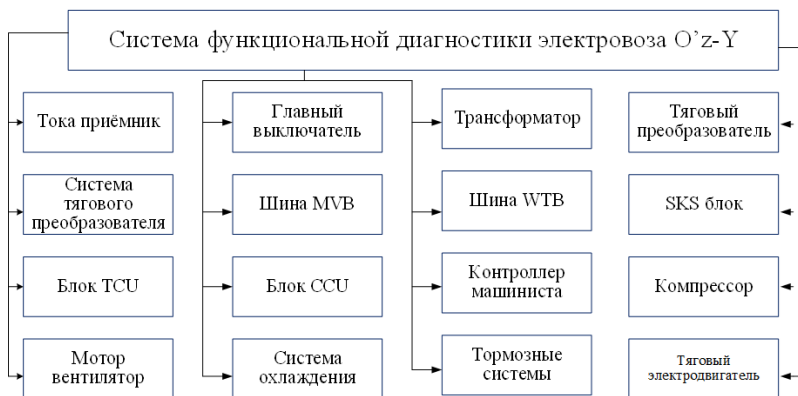
Рис. 1. Система функциональной диагностики электровоза О'z-Y
