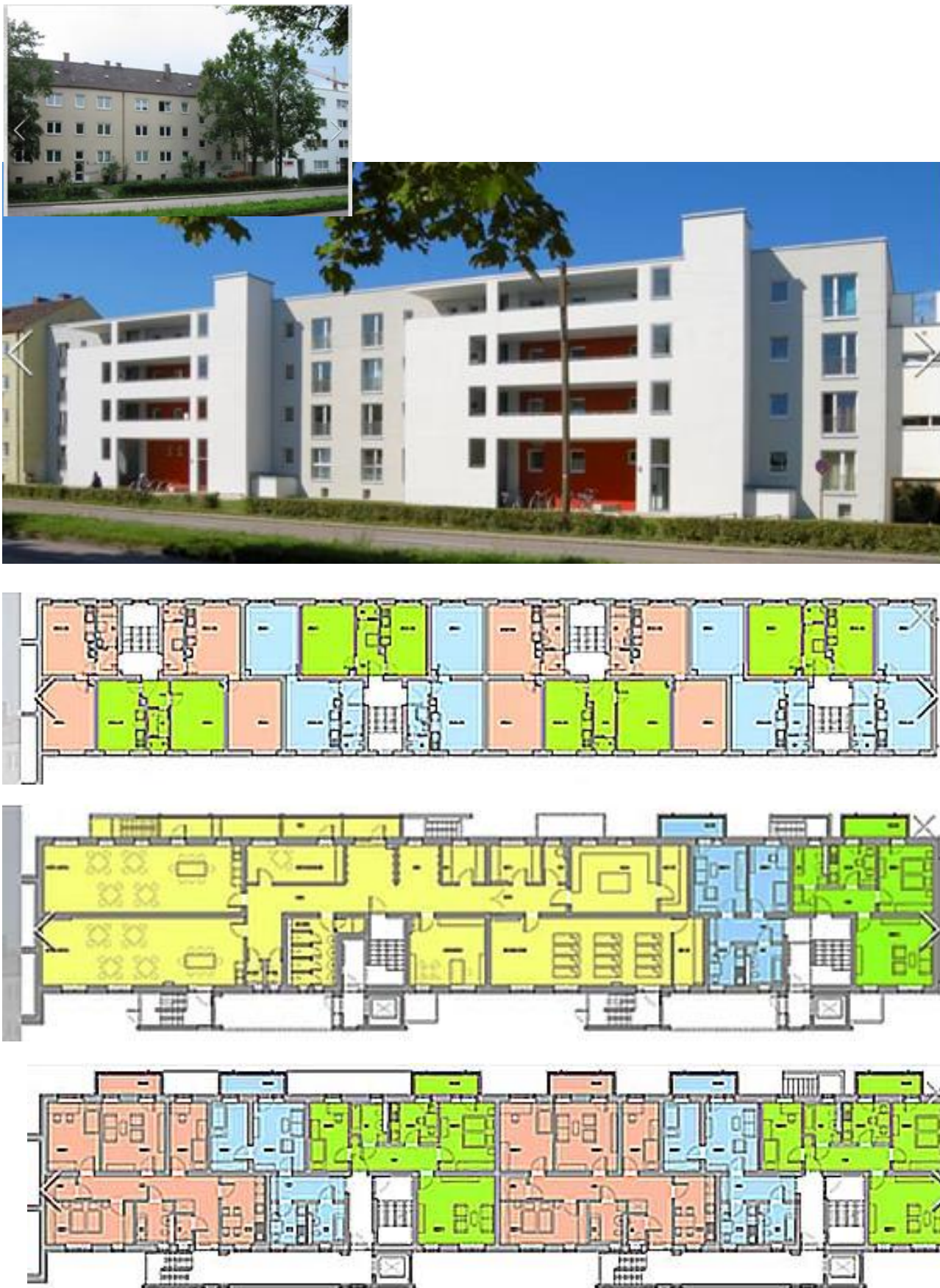
Рис. 2. 15. Реконструкция четырёхэтажного здания по ул. Schleissheimerstrasse-313 в Мюнхене. Общий вид здания до и после перестройки. План дома до перестройки, план типового и первого этажа после перестройки
