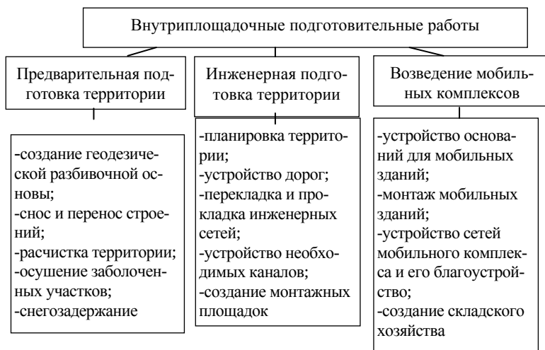
Рисунок 2 – Внутриплощадочные подготовительные работы
