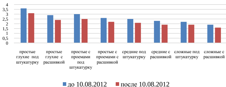
Рисунок 2 – Изменение сменной выработки при выполнении работ по кирпичной кладке стен до и после утверждения результатов нормирования постановлением Министерства архитектуры и строительства Республики Беларусь № 24 от 10.08.2012г., \text{м}^3
