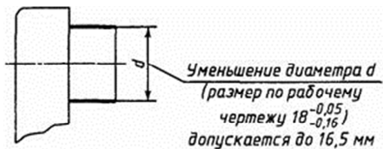
Рис. 3.2. Буквенное обозначение обрабатываемых или восстанавливаемых поверхностей и указание их числовых значений на полке линии-выноски
