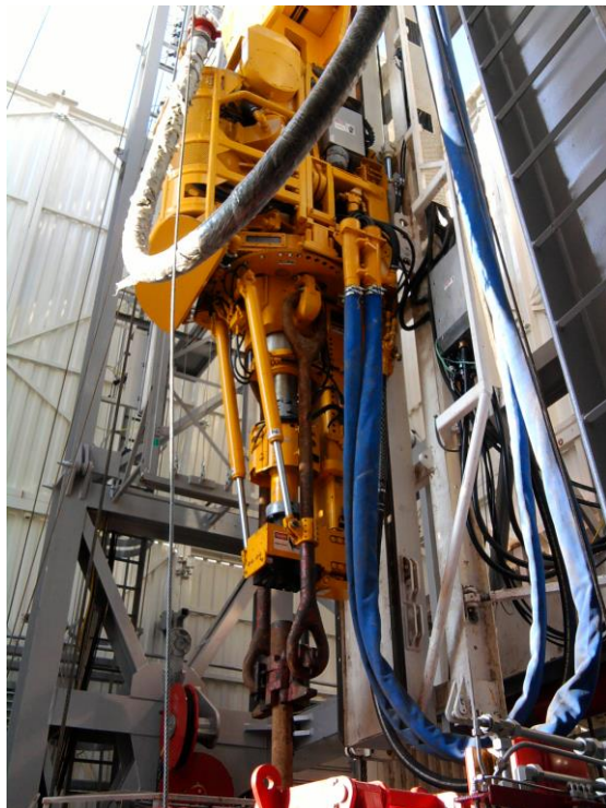
Рис. 1. Общий вид верхнего привода буровой колонны «Bentec»
