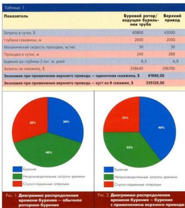
Рис. 2. Диаграммы распределения времени бурения в зависимости от типа привода буровой колонны
