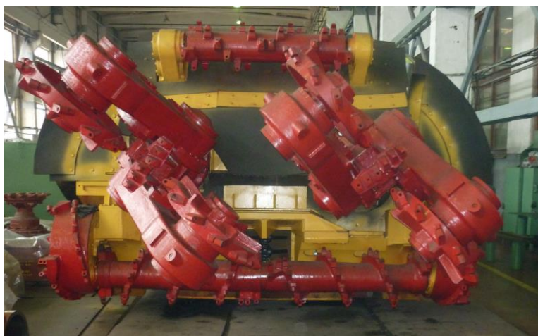
Рис. 1. Вид на спаренный планетарно-дисковый исполнительный орган комбайна КПО-10,5
