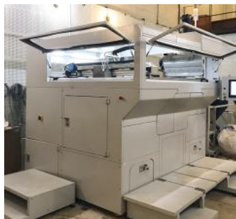
Рисунок 1 - 3d-принтер ( a ) для литейных форм из плакированных смесей и напечатанная форма ( б )
