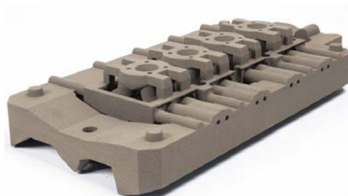
Рисунок 1 - 3d-принтер ( a ) для литейных форм из плакированных смесей и напечатанная форма ( б )
