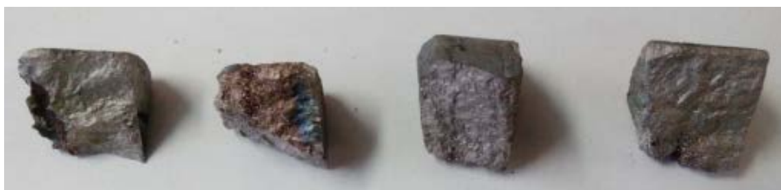
Рисунок 2 – Макроструктура литого комплексного силицида кремний-титан-никель
