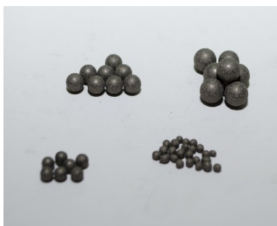
Рисунок 4 – Шары различных диаметров для активации процесса размола силицидов
