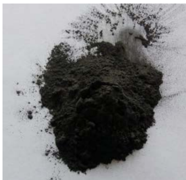
Рисунок 5 – Общий вид порошка комплексного силицида после размола (размер фракции до 0,08мм)
