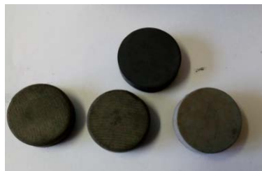
Рисунок 3 – Восстановительные брикеты на основе ванадийсодержащих отходов
