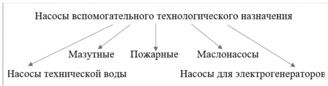
Рисунок 3 – Классификация насосов вспомогательного технологического назначения
