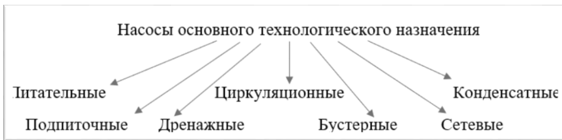
Рисунок 2 – Классификация насосов основного технологического назначения
