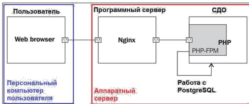
Рисунок 2 – Логическая схема взаимодействия компонентов, обеспечивающих работу пользователей с СДО
