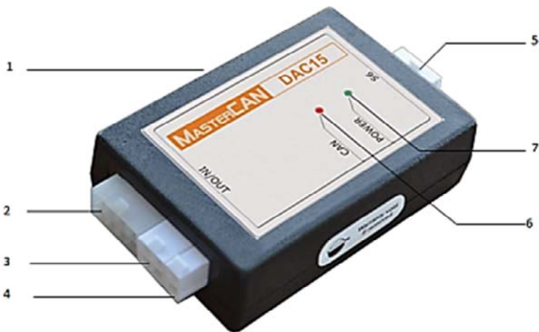
Рис. 2.10. Преобразователь MasterCAN DAC-15: 1 – корпус; 2 – разъем I/D1/D2/R (токовый/дискретный 1/ дискретный 2/ резистивный выходы); 3 – разъем A/F (вход и выход аналогового напряжения/частотный); 4 – разъем POWER (подключение питания бортовой сети ТС); 5 – разъем S6 (подключение к автомобильному интерфейсу CAN/S6); 6 – красный светодиодный индикатор CAN; 7 – зеленый светодиодный индикатор POWER
