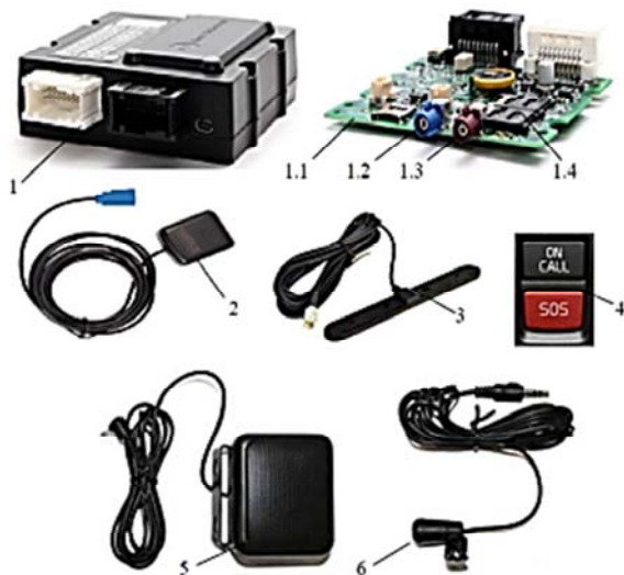
Рис. 1.6. Состав оборудования системы «ЭРА-ГЛОНАСС», устанавливаемого на борту АТС:
