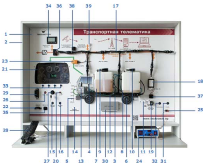
Рис. 2.1. Устройство учебного стенда «Транспортная телематика»
