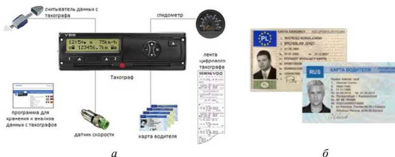
Рис. 1.3. Компоненты цифрового тахографа: а – и внешний вид электронных карт; б – идентификация водителя
