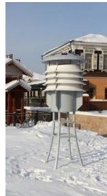
Рисунок 8. ВЭУ AeroGreen 1 кВт
