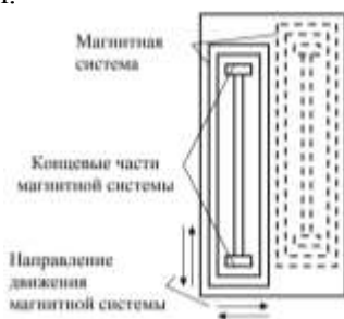
Рис. 4. Подвижная магнитная система магнетрона с прямоугольной мишенью
