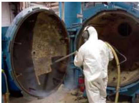
Рис. 1. Очистка вакуумной камеры механическим методом
