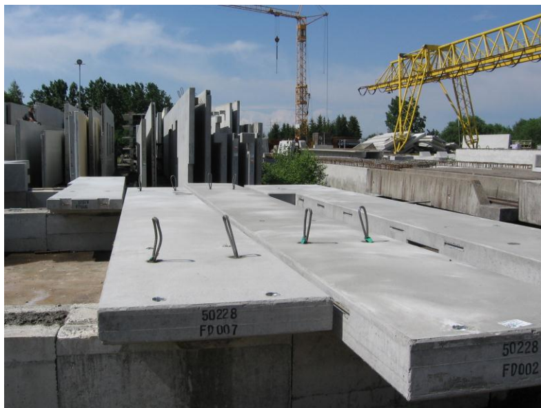
Рисунок 2. Панели перекрытия с упрощённым профилем
