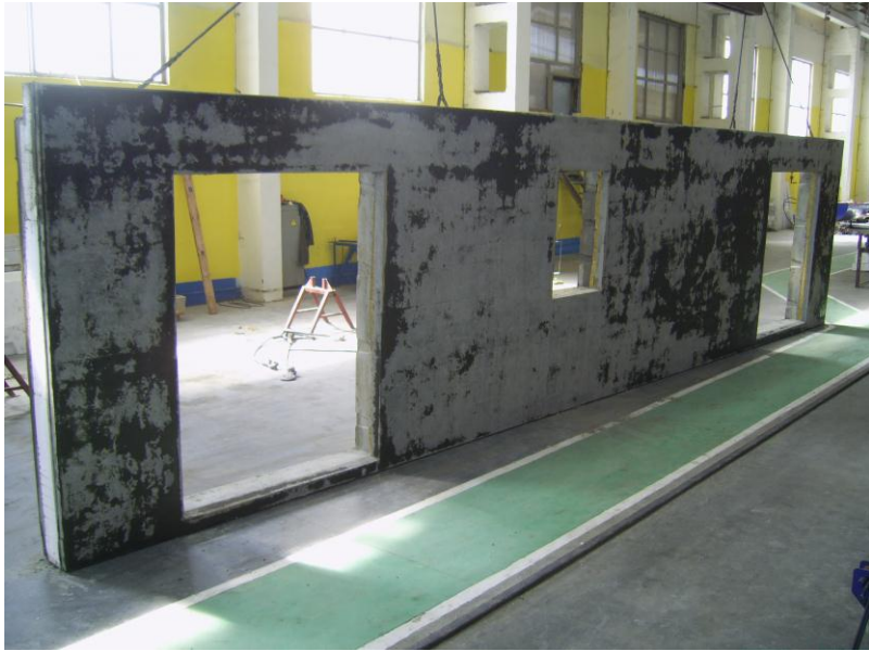
Рисунок 4. Экспериментальная 3-слойная наружная стеновая панель длиной 1 2м с термическим сопротивлением 4.5 \text{ м}^2 \cdot \text{С/Вт}
