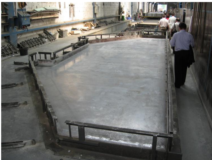
Рисунок 3. Производство стеновой панели нестандартной формы
