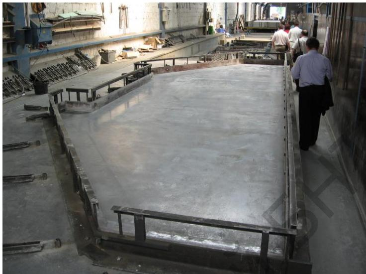
Рисунок 3. Производство стеновой панели нестандартной формы
