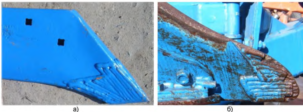
Рисунок 1 – Электродуговая наплавка носка плужного лемеха. Rabewerk а) – новый; б) – после выработки 15 Га на каменистых почвах
