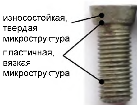
Рисунок 12 –Требуемое распределение структур по сечению упрочненного крепежного элемента
