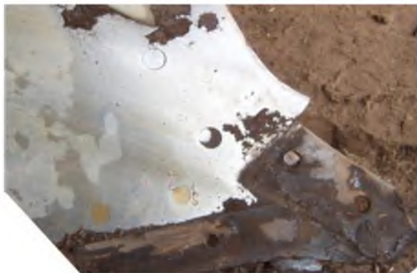
Рисунок 11 – Корпус плуга с утраченными долотом и лемехом из-за разрушения шляпок крепежных болтов. Выработка 21 Га. Песчаные почвы
