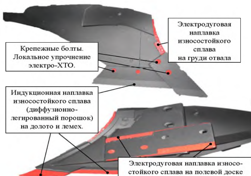
Рисунок 15 – Корпус плуга Минского завода шестерен с упрочненными быстроизнашиваемыми деталями
