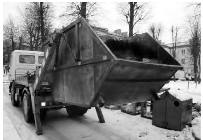
Рис. 6. Автомобиль, снабженный технологическим оборудованием в виде съемного контейнера для вывоза целлюлозосодержащих отходов на свалку
