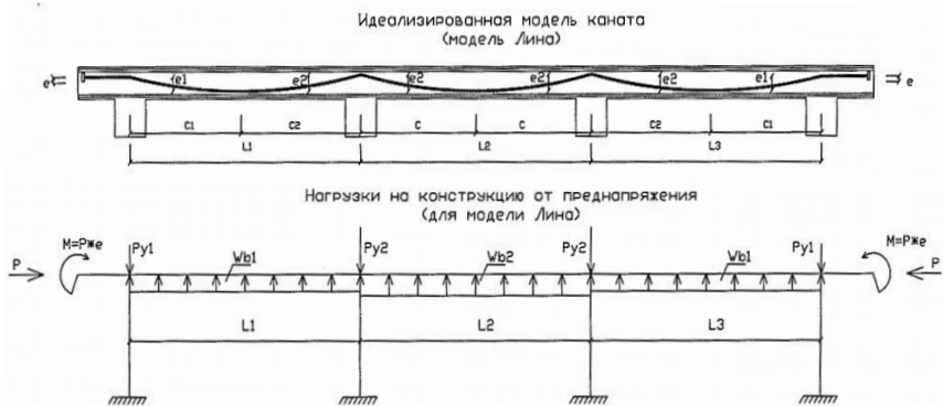
Рисунок 1. Идеализированная модель арматурного каната (по модели Лина)
