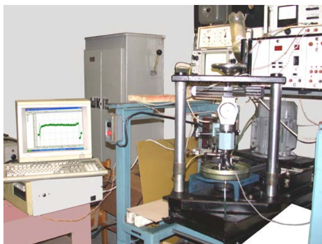
Рис. 2. Фото машины трения одностороннего вращения
