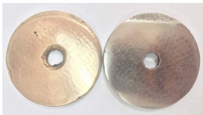
Рис. 1. Экспериментальные образцы дисков с покрытиями для проведения испытаний на трение и износ
