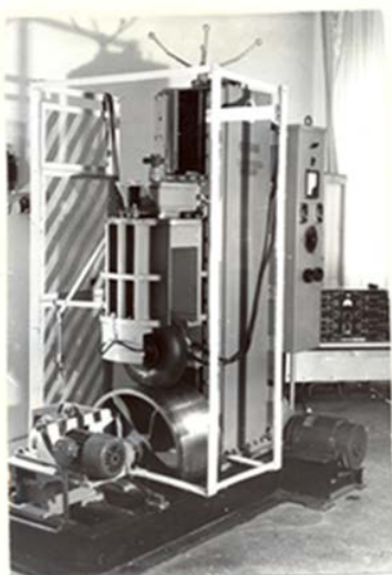
Рис. 1.3. Общий вид и принципиальная схема установки для испытания шин
