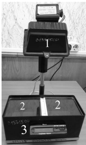
Рисунок 2. Лабораторная установка для моделирования парникового эффекта.
