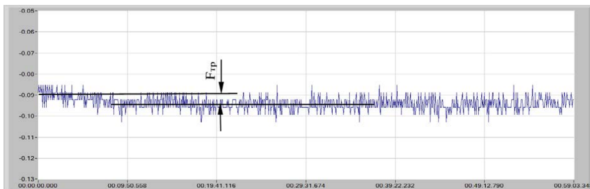
Рис. 3. Осциллограмма отклонений силы трения F_{тр} при трении сферического индентора по диску с покрытием ПТ-ЮНХ16СР3 (основа Ni; 0,7 % C; 16 % Cr; 3,2 % Si; 2,6 % B; 1,2 % Al)
