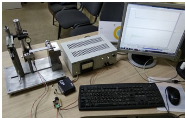
Рис. 2. Общий вид экспериментального стенда для испытаний демпфирующих свойств образцов
