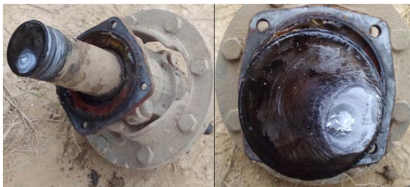
Рис. 1. Типичное усталостное разрушение полуоси заднего ведущего моста колесного трактора
