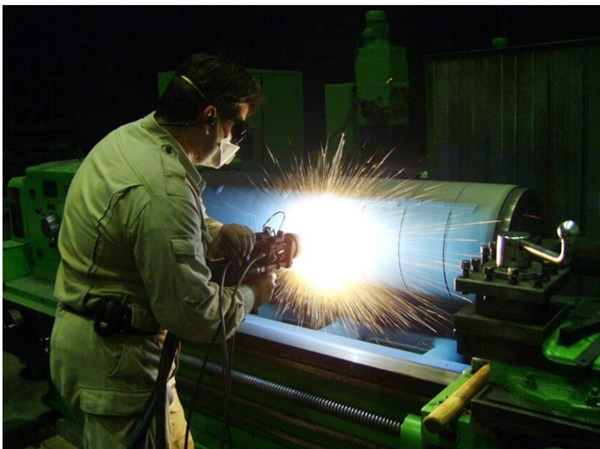
Рис. 1. Установка гиперзвуковой металлизации в процессе напыления покрытий стальными проволоками
