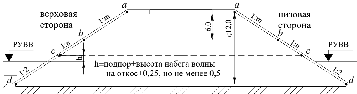
Рисунок 2.8.5 – Поперечное сечение насыпей подходов с верховой стороны (левый откос) и с низовой стороны (правый откос): РУВВ – расчетный уровень высокой воды, h – подпор, h_{наб} – высота набега волны на откос
