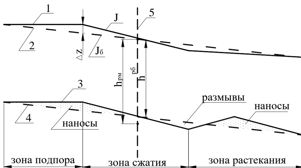
Рисунок 2.3.2 – Продольный профиль реки в зоне мостового перехода: 1, 2 – поверхность воды в подмостовых условиях и в бытовых; 3, 4 – дно реки в бытовых и подмостовых условиях; 5 – ось перехода.
