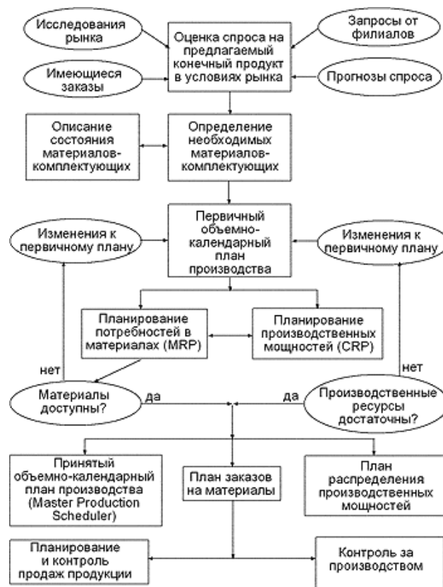
Рисунок 3.1 – Логическая структура системы планирования ресурсов производственного предприятия
