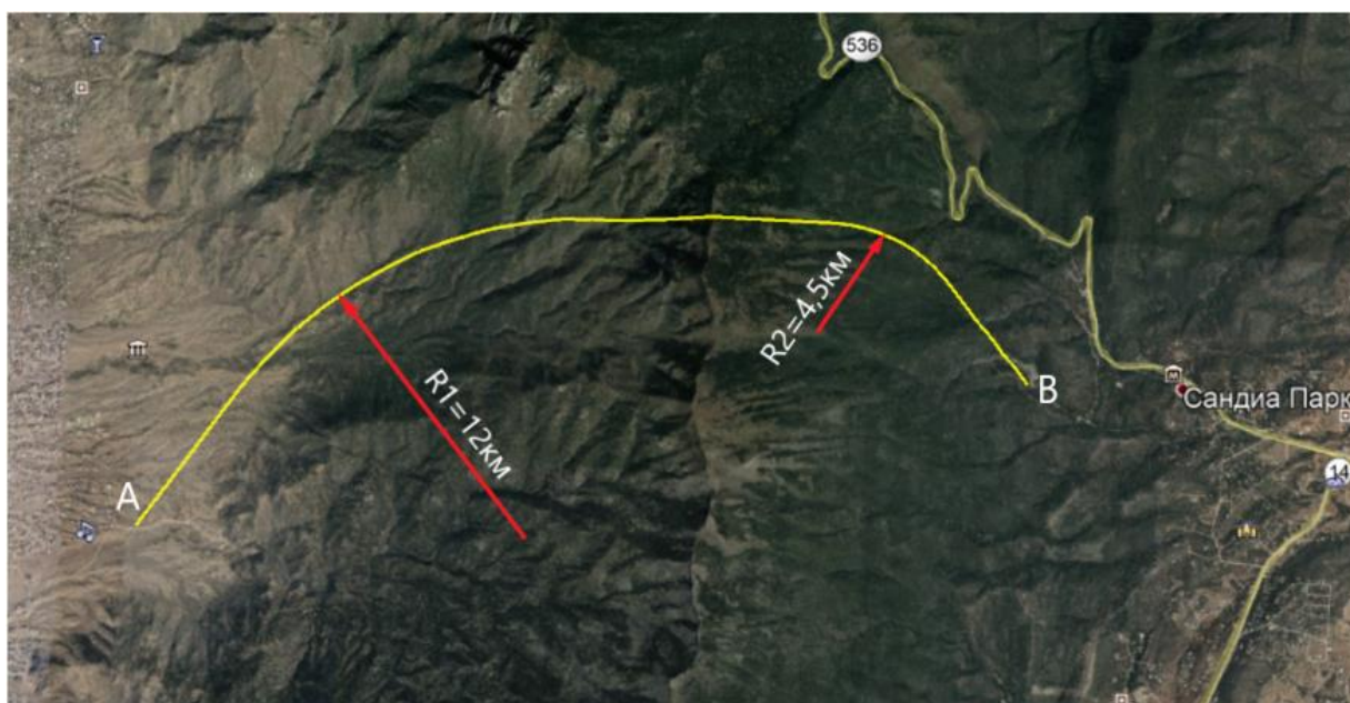
Рисунок 1 – Генеральный план трассы
